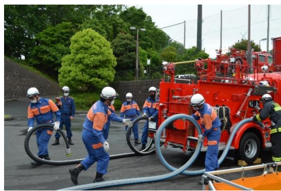
〔動力消防ポンプ性能試験の様子〕
